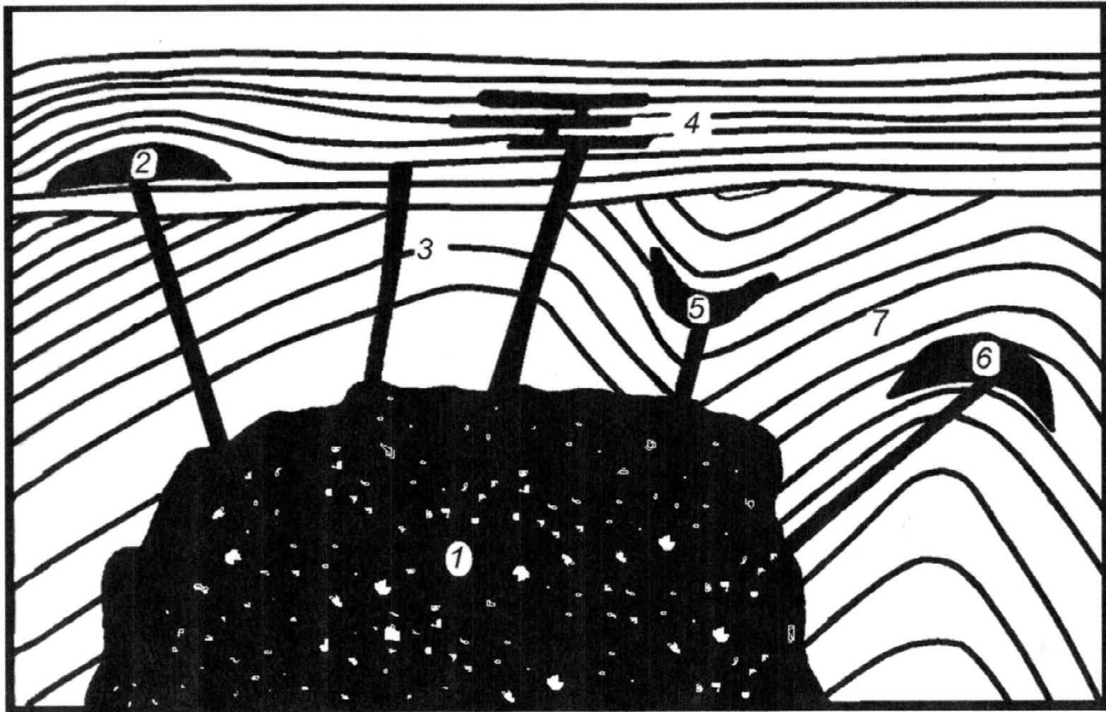
Рис. 3. Формы залегания интрузивных пород: 1 – батолит; 2 – лакколит; 3 – дайка; 4 – пластовая залежь или силл; 5 – лополит; 6 – факолит; 7 – осадочные породы
